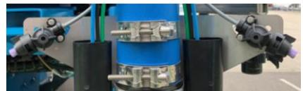
➤ Dans le cas de rognages hauts, possibilité d'ajouter une 4<sup>ème</sup> hauteur de diffuseurs, soit en version diffuseurs identiques aux 3 autres hauteurs ou bien en version jet projeté.
