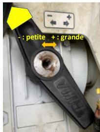
➤ En **entraînement mécanique** : réglez la poignée derrière la turbine en position petite ou grande vitesse. Veillez à bien pousser la poignée jusqu'en butée.
