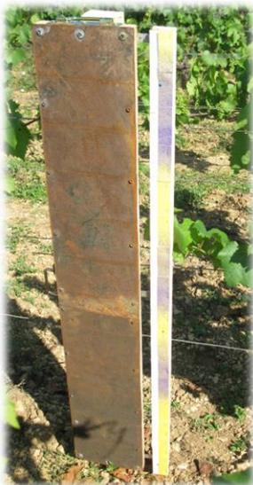
Une plaque de fer rouillée, ou recouverte d'une peinture de couleur noire et mate et/ou une bande verticale de papiers hydro-sensibles vous permettront de juger rapidement de vos réglages.
