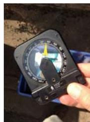
➤ Réglez tous les angles de diffuseurs de façon identique grâce à l'inclinomètre.
