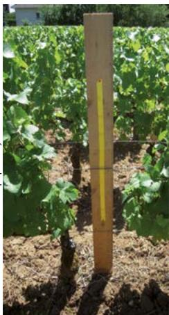
► Placez une bande verticale de papiers hydrosensibles de 80 cm au dos de votre plaque noire (soit en collant des PHS classiques de 7cm sur une longue bande de scotch ou bien en disposant de bandes de PHS de 50cm). Cela vous laissera une trace de votre essai et vous permettra par la suite de comparer différents réglages entre eux.
