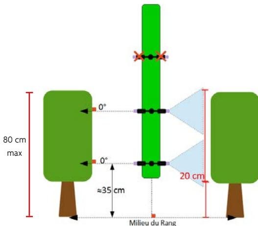
➤ Réglez horizontalement les diffuseurs du bas et du milieu. Le centre de la zone à couvrir doit correspondre au centre entre les 2 diffuseurs.
