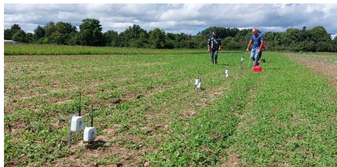
Mise en place de sondes connectées pour irriguer « la bonne quantité au bon moment » Chambre d'Agriculture de la Nièvre
