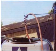
Il est obligatoire de mettre en œuvre un moyen de protection du réseau d'eau ne permettant **en aucun cas le retour de l'eau vers le circuit d'alimentation** :
