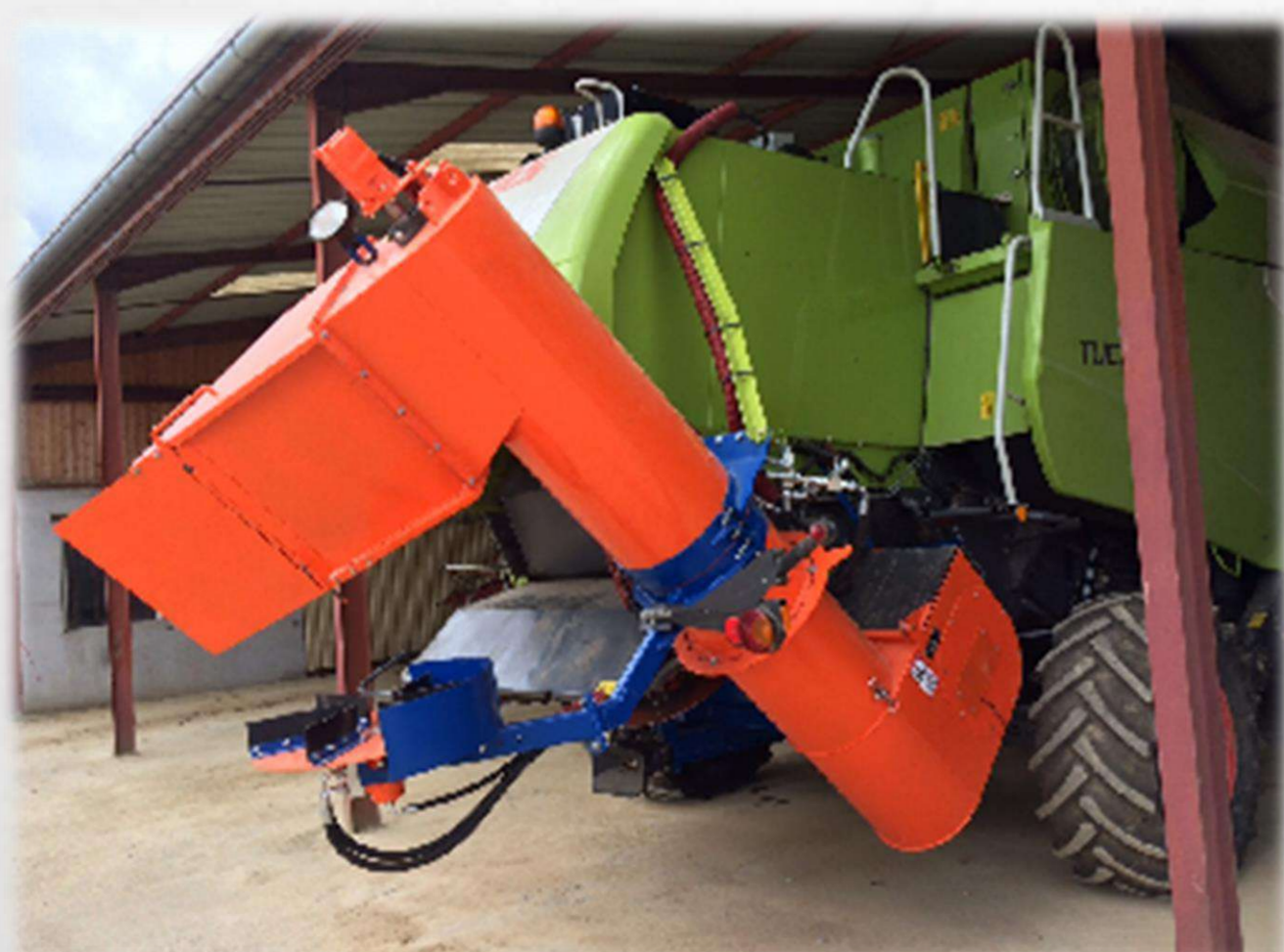
Equipement de récolte de la menue paille (sur l'andain) GAEC De Le Foulrière
